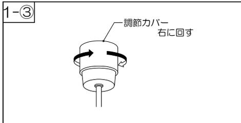
③コード収納引掛シーリングキャップの調節カバーが天井面にあたるまで右に回してください。
