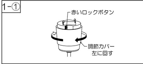
①調節カバーを左に回して、赤いロックボタンが見えるまで調節カバーを下げてください。
