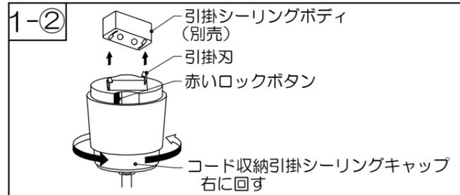
②電源コードをまっすぐに伸ばしてください。コード収納引掛シーリングキャップの2本の引掛刃を引掛シーリングボディに挿入し、カチッと音がするまでコード収納引掛シーリングキャップを右に回してください。
