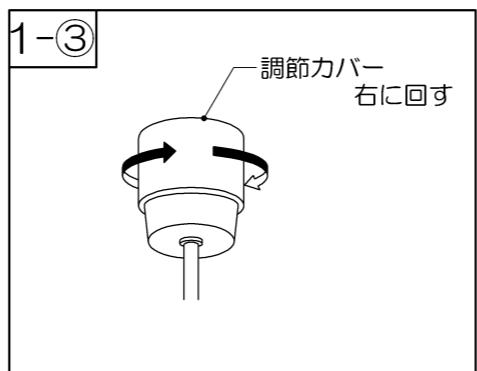
③コード収納引掛けシーリングキャップの調節カバーが天井面にあたるまで右に回してください。
