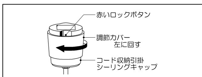
①コード収納引掛けシーリングキャップの調節カバーを左に回して、赤色のボタンが完全に見えるまで下げてください。
