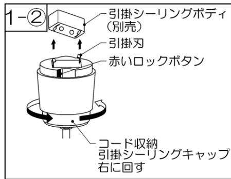
②電源コードをまっすぐに伸ばしてください。コード収納引掛シーリングキャップの2本の引掛刃を引掛シーリングボディに挿入し、カチッと音がするまでコード収納引掛シーリングキャップを右に回してください。
