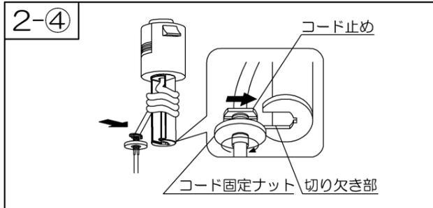
④ 電源コード、コード止めを支柱の切り欠きにはめ込み、コード固定ナットを締め込んで固定します。
