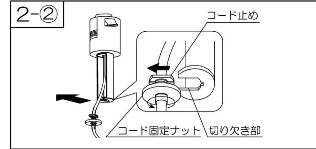
② コード固定ナットをゆるめ、コード止めと電源コードを切り欠きからはずし、静かに下ろします。
