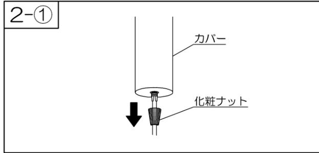
① 化粧ナットをゆるめ、化粧ナットとカバーを支柱からはずしてください。
