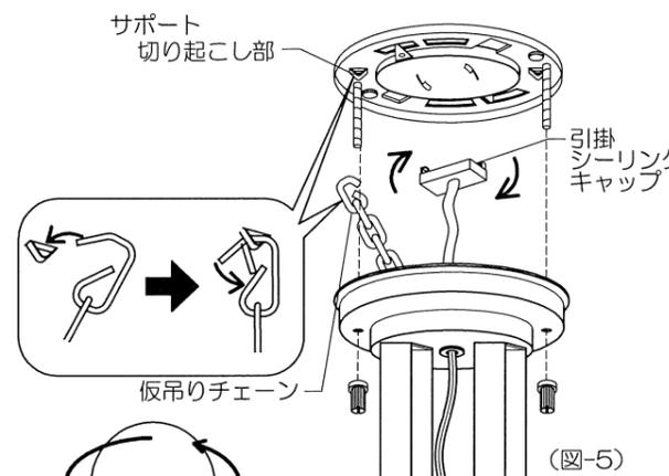
2.仮吊りチェーンをサポートの切り起こし部に引っ掛け、器具本体を仮吊りしたあと、ペンチなどでチェーンを閉じてください。(図-5)
