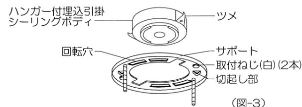
アウトレットボックス、コンクリートボックス、アンカーボルトへ
