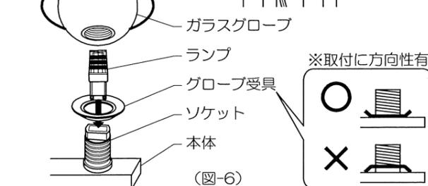
6.ランプとソケットにグローブ受具を通し、本体を支えながらガラスグローブをソケットにねじ込みます。(計3個)(図-6)
