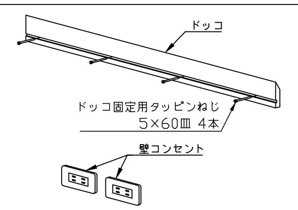
③ドッコ固定用タッピンねじで、ドッコを壁面に固定します。
