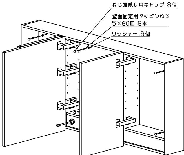
⑥キャビネット内面に、壁面固定用タッピンねじ用の下穴を開けます。
