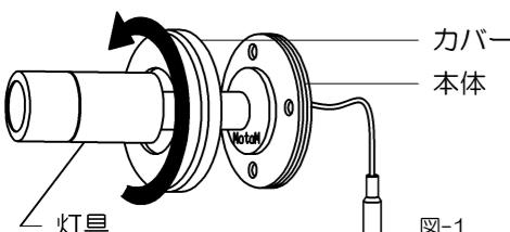
1. 灯具を図のようにまっすぐにして、カバーを矢印の方向に回して本体からはずします。（図-1）
