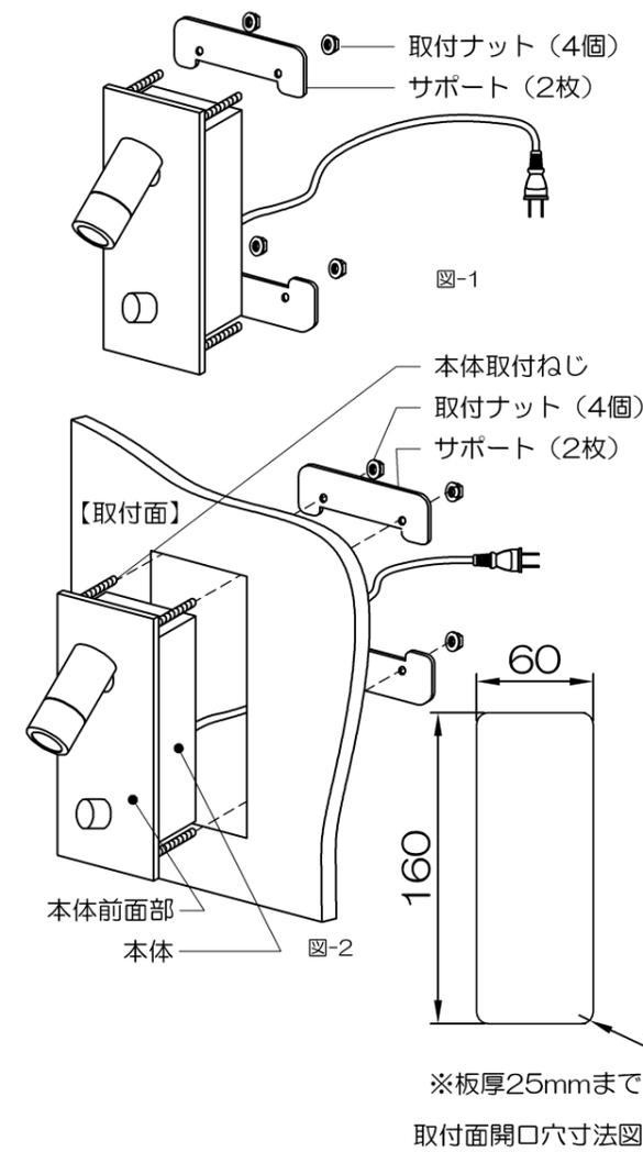
1. 取付ナット（4個）をゆるめて本体からサポート（2枚）をはずします。（図-1）
