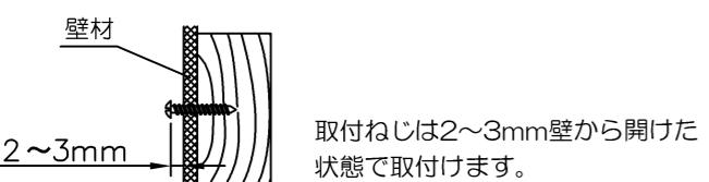
3. ミラー本体の裏面の取付穴に壁のねじが入る様に差し込み
