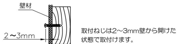
取付ねじは2～3mm壁から開けた状態で取付けます。
