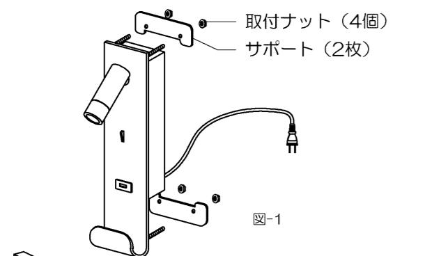
1.取付ナット（4個）をゆるめて本体からサポート（2枚）をはずします。（図-1）
