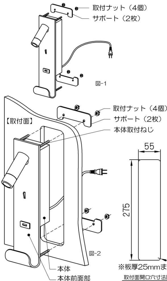
1.取付ナット（4個）をゆるめて本体からサポート（2枚）をはずします。（図-1）
