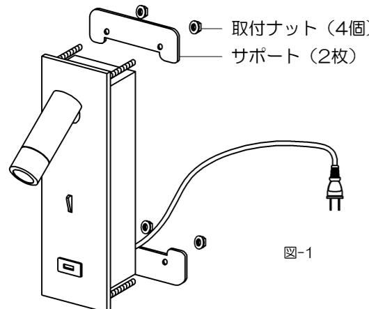
1.取付ナット（4個）をゆるめて本体からサポート（2枚）をはずします。（図-1）
