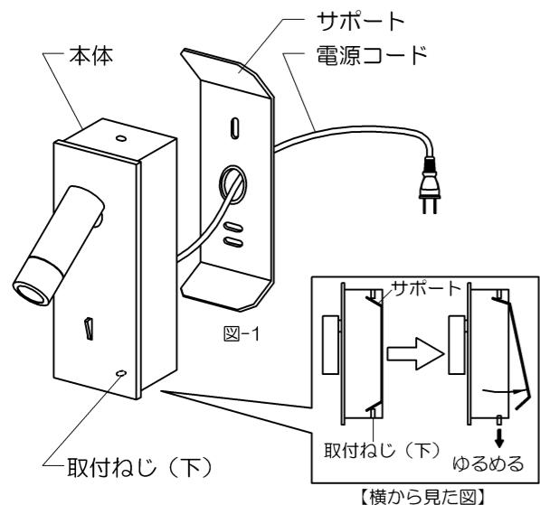
1.取付ねじ(下)を付属の六角レンチでゆるめて本体からサポートをはずします。(図-1)
