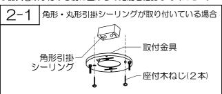
付属の取付金具を引掛シーリングの中心に合わせて付属の座付 木ねじ(2本)で確実に取り付けてください。
