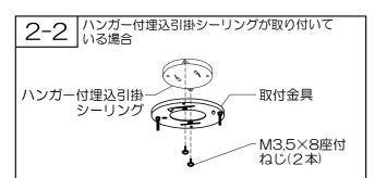
付属の取付金具をハンガー付埋込引掛シーリングの中心に 合わせて付属のM3.5×8座付ねじ(2本)で確実に取り付け てください。
