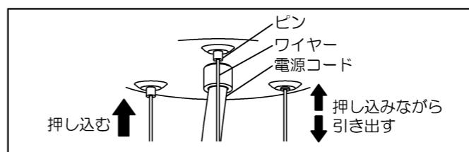
器具の全長はワイヤー長を調節することにより、700mm~2000mmの範囲で設定できます。
