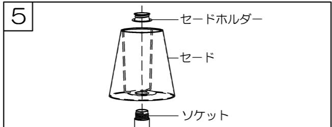
ソケットにセードを通し、セードホルダーをねじ込んで確実に固定してください。
