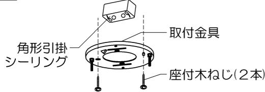
付属の取付金具を引掛けシーリングの中心に合わせて付属の座付木ねじ(2本)で確実に取り付けてください。
