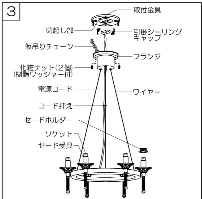
① 仮吊りチェーンを取付金具の切起し部に引掛け、器具本体を仮吊りしたあと、ペンチなどでチェーンを閉じてください。
