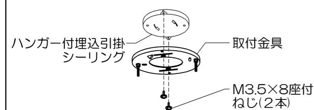
付属の取付金具をハンガー付埋込引掛けシーリングの中心に合わせて付属のM3.5×8座付ねじ(2本)で確実に取り付けてください。
