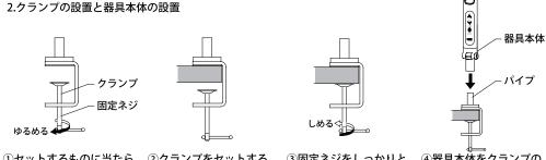
①セットするものに当たら ②クランプをセットする ③固定ネジをしっかりと 4器具本体をクランプの ものにくわえさせます。 ない広さまで固定ネジを しめこみます。 上部のパイプにさしこ ゆるめます。 みます。
