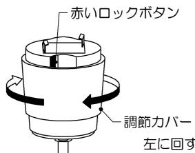
1.調節カバーを左に回して、赤いロックボタンが見えるまで調節カバーを下げてください。
