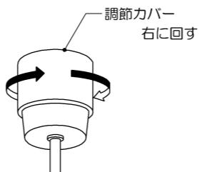
3.コード収納引掛けシーリングキャップの調節カバーが天井面にあたるまで右に回してください。
