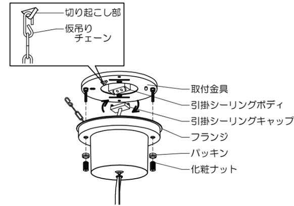
3.仮吊りチェーンをサポートの切り起こし部に引掛け、器具本体を仮吊りします。
