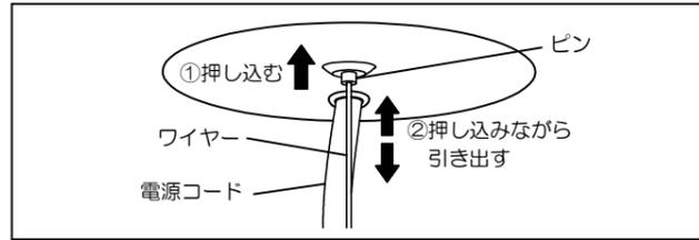
器具の全長はワイヤー長を調節することにより、900mm～1500mmの範囲で設定できます。
