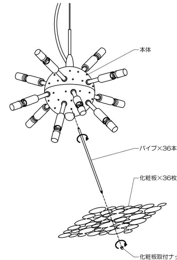
1.本体に付属のパイプを最後まで確実にねじ込みます。
