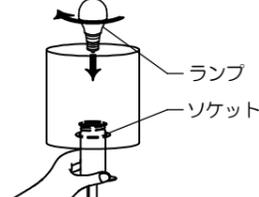
3.ソケットの根元を支えながら付属のランプをソケットにねじ込みます。
