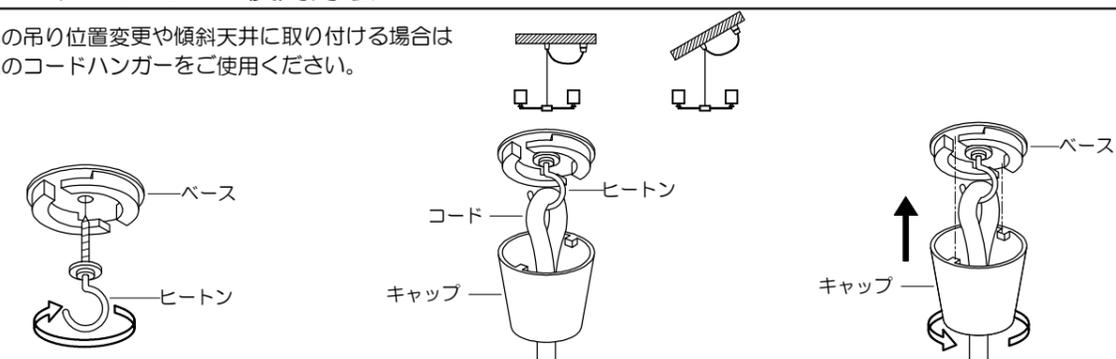
1.天井面の補強材のある位置に、ヒートンを使ってベースを固定してください。
