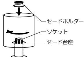
2.ソケットにセードの台座部分を通して、セードホルダーをねじ込んで確実に固定してください。
