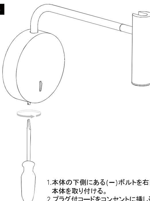
1. 本体の下側にある(－)ボルトを右回転させ、本体を取り付ける。
