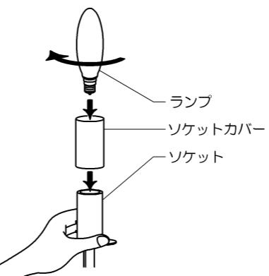
ソケットにソケットカバーを通し、根元を支えながら付属のランプをソケットにねじ込みます。
