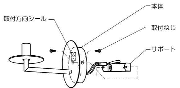
5.本体内面の取付方向に従って、サポートの穴と本体の穴の位置を合わせ、取付ねじを締めて固定します。
