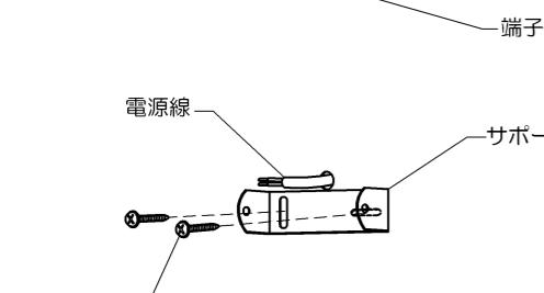
3.サポート取付寸法図を参照し、付属の座付木ねじでサポートを壁面の取付面に確実に取り付けてください。
